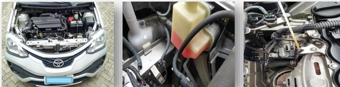
**2.2 - Foto do Cofre do Motor**, com registro da placa dianteira na mesma foto, evidenciando as partes externas do motor, (bateria, filtro de ar, coletores), reservatórios (aditivo radiador) e vareta de óleo (óleo lubrificante sem contaminação).
